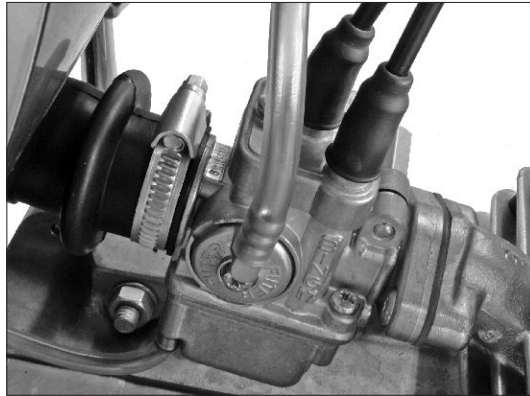
BING-Vergaser im eingebauten Zustand, hier am Mokick
